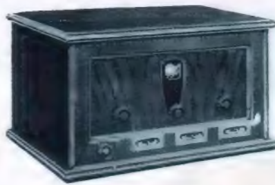
Links oben: Auch der „Siemens 21“, ein Zweiröhren-Netzgerät, ist mit der typischen Riesenskala ausgerüstet.
