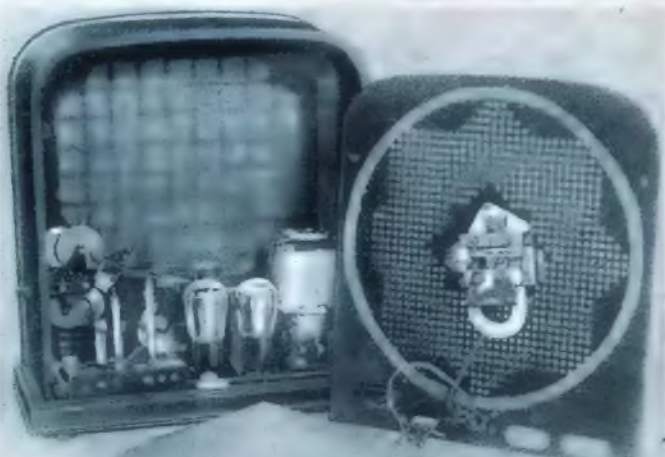
Links: Innenansicht des Telefunken 12 mit den Spulen (links), den beiden Röhren, dem Lautsprecher-system und dem Konus.
