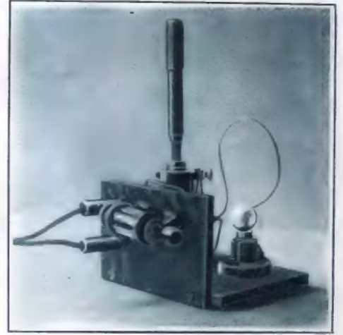
Abb. 6. Der Detektorempfänger für den Versuch mit ultrakurzen Wellen.
