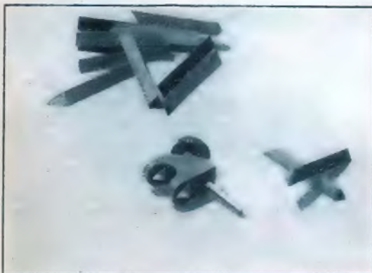
Ein Zwischenstück, das die dreikantigen Holz-nadeln in normalen Dosen zu spielen gestattet. Dieses Zwischenstück ist in Deutschland nicht erhältlich, kann von Bastlern aber leicht selbst gebaut werden.
