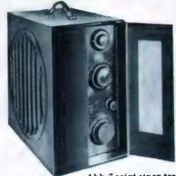
Abb. 7 zeigt einen transportablen Empfänger mit Netz-Anschluß und einer interessanten Anordnung der Bedienungshebel
