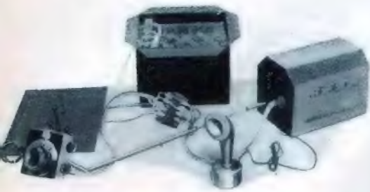
Abb. 11 Autoempfänger mit Fernbedienung. Links das sogenannte „Kontrollkästchen“.
