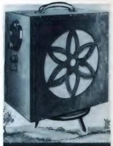
Abb. 3. Ein modernes 2-Röhrengerät, das auch den Fußgänger nicht allzusehr belastet
