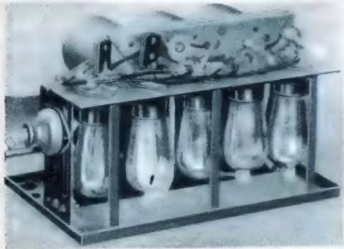
Abb. 12. Der gleiche Empfänger, von der Rückseite gesehen, zeigt besonders deutlich das Eisenchassis, das alle Teile trägt.
