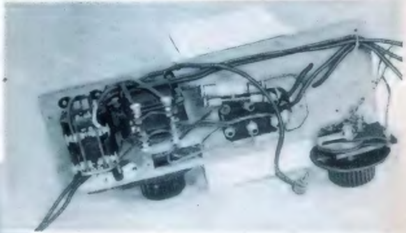
Die Schaltplatte von unten, links die beiden NF-Transformatoren, in der Mitte der Ableitwiderstand mit dem Gitterblock freischwebend an den Leitungen. Rechts der Kondensator des ersten Kreises
