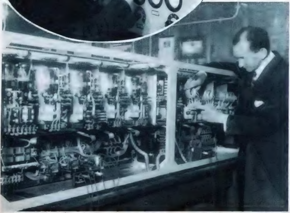
Rückansicht des 12-Röhren-Amerika-Empfängers. Phot. Atlantik. •
