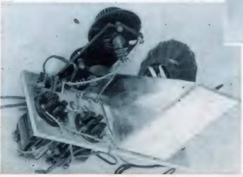
Die Schaltplatte von unten, links die beiden NF-Transformatoren, in der Mitte der Ableitwiderstand mit dem Gitterblock freischwebend an den Leitungen. Rechts der Kondensator des ersten Kreises
