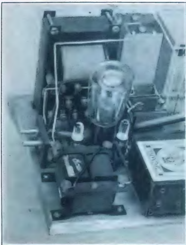
Der Gleichrichterteil. Im Hintergrund der Netztrafo, in der Mitte die Glimmgleichrichterröhre, rechts vorne die Gitterbatterie.
