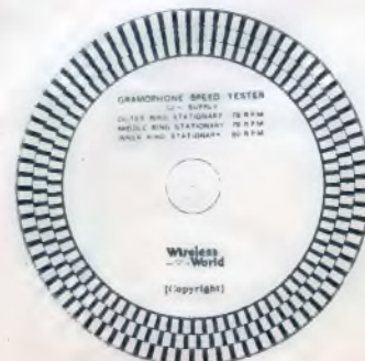
Abb. 1. Eine Anordnung zur Kontrolle der Umdrehungszahl des Grammophonplattentellers.
