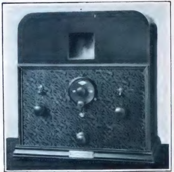
Universalempfänger der Telehor A.-G. mit einseitigem Röhren-Oszillator, Verstärker und Netzanschlußgerät zur Erzeugung des örtlichen Gleichlaufstromes. Phot. Telehor A.-G.
