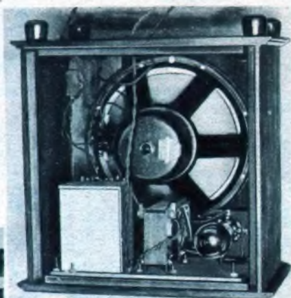
In einem Gehäuse sind Lautsprecher und Gleichrichter vereinigt Phot. Hattwich
