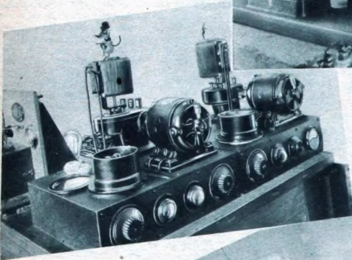
Selbsttätige Regelinrichtungen sorgen für Konstanzhaltung der Umdrehungszahl der Maschinen und damit der Frequenz
