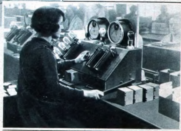
Das drehbare Montagegestell, der Clou der Bandfabrikation.
