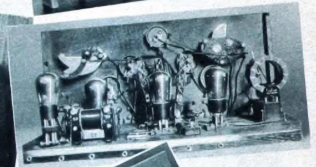
Ein trennscharfes Audion, ein Hochfrequenzvorsatz u. der Zweistufiger
