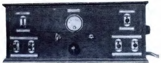
Abb. 2. Die sechs Hebel, nach oben oder unten gedrückt, bringen den gewünschten Sender ohne alles weitere Zutun klargrein in den Lautsprecher.
