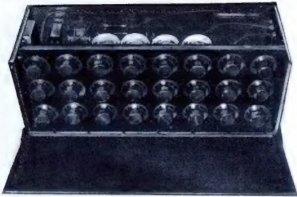
Abb. 1. Zu jedem Sender gehören zwei eigene Drehkondensatoren. An dem Mustergerät sind es 24 solcher Drehkondensatoren, die, einmal abgestimmt, nicht mehr bedient zu werden brauchen.
