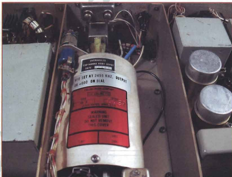
foto 15: il VFO Collins revisionato foto 16: la sincronizzazione del VFO foto 17: sensitivity test finale
