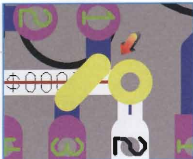
figura 19 Un problema di distanza tra le linee collegate ai pad 2 e 3 di U2
