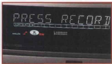
foto 2: Il registraCD Philips CDR570 in pausa, ingresso analogico abilitato, uscita S/PDIF attiva
