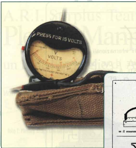
Sopra, foto 2: lo strumentino mod. K a due portate da 12 e 240V
