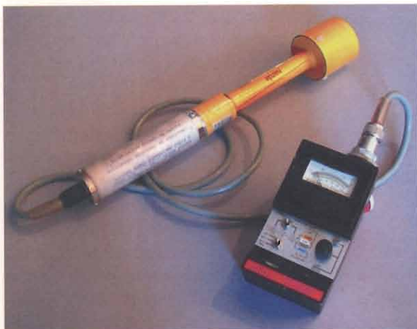
figura 1 - Misuratore di intensità campo elettrico a larga banda (300MHz - 40GHz) con sensore a termocoppia. La sonda intercambiabile è collegata all'indicatore da un cavo di 1,5m ed è dotata di un lungo manico affinché l'operatore possa allontanarla a sufficienza ed evitare che la sua presenza perturbi il campo che si deve misurare.
