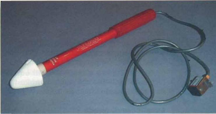
figura 3 - Sonda "sniffer" per misurare campi elettrici nei punti di perdita dalle linee di trasmissione e da forni a microonde. Queste sonde hanno generalmente elevata sensibilità e sono a banda piuttosto stretta. Il radome conico di polistirolo deve essere appoggiato nel punto ove fuoriesce la RF.
