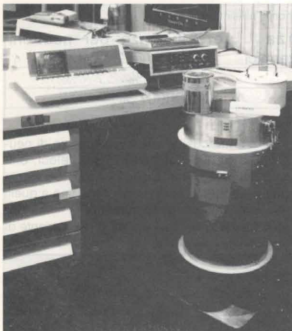
figura 11 - Un rivelatore al trifluoruro di boro con relativi accessori: alimentatore/preamplificatore (sul banco, a dx) e multicanale (a sx). Il tubo contatore, immerso nel bidone di moderatore (acqua) in basso a dx che contiene anche una sorgente di neutroni da laboratorio, non è visibile.
