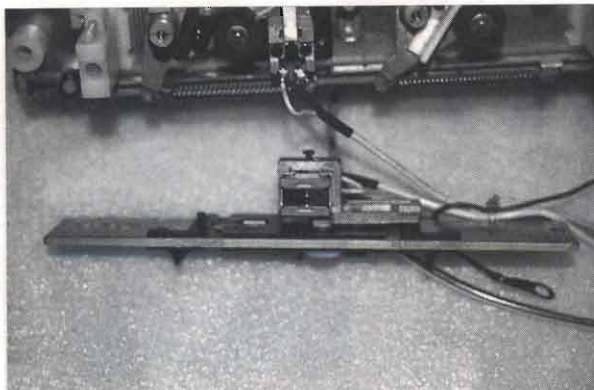
Foto 12 - Lo smontaggio della piastra contenente la testina audio.
