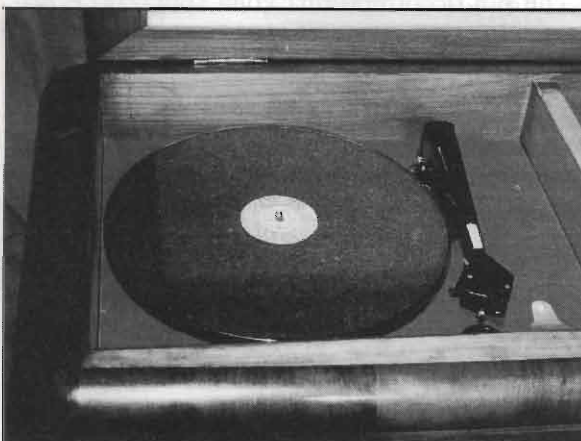
Foto 8 - La piastra giradischi, con braccio a testa elettromagnetica e puntine intercambiabili.
