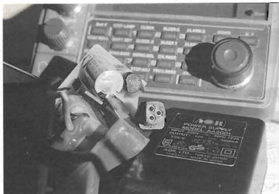
Foto 2 - Alimentatore modificato, si notano C3÷C6 e IC1.
