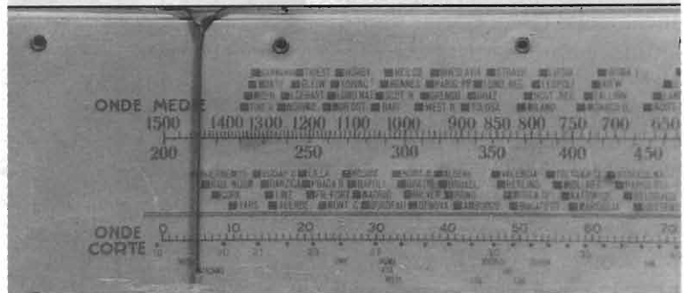
figura 3b - Particolare della scala: le Onde Corte.
