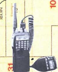
IC 2 GX ET - Portatile bibanda VHF/UHF in FM caratterizzata da semplicità operativa, alta potenza RF (7W) ed impermeabilità a polvere e schizzi d'acqua.
