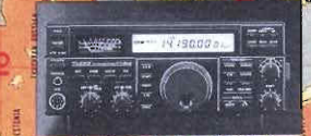
IC 820 - Rx: 100 kHz/30 MHz - Tx: da 1,8 a 30 MHz - 100W RF in SSB, CW e AM - 25W in FM - 100 memorie
