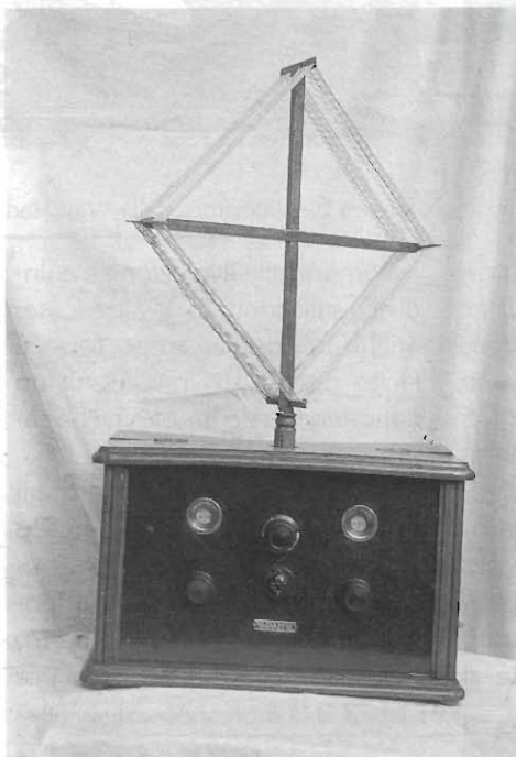
figura 2 - Ricevitore Magnadyne Super Neutro VII del 1925/27. Questo apparecchio è stato descritto su E.F. n° 6 del giugno 1991.
