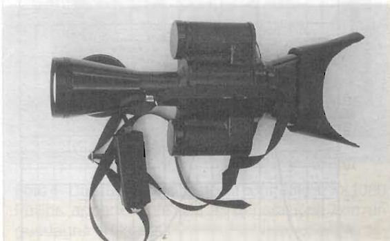
Foto 1 - Moderno cannocchiale per intensificazione di immagine provvisto di schermo ottico per la visione bi-oculare, monta un tubo della 2ª generazione plus a microcanali.
