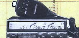
TM-742 E - Veicolare multibanda 144 e 430 MHz più una terza (28-50MHz-1.2 GHz)
