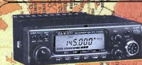
FT 2200 5/25/50W in VHF, 5/20/35W in UHF 49 memorie - canalizzazione da 5 a 50 KHz
