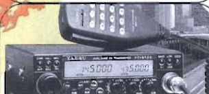
YAESU FT 5100 - Ricetrasmittitore veicolare con Duplexer incorporato RxTx 144-148 MHz/430-440 MHz.
