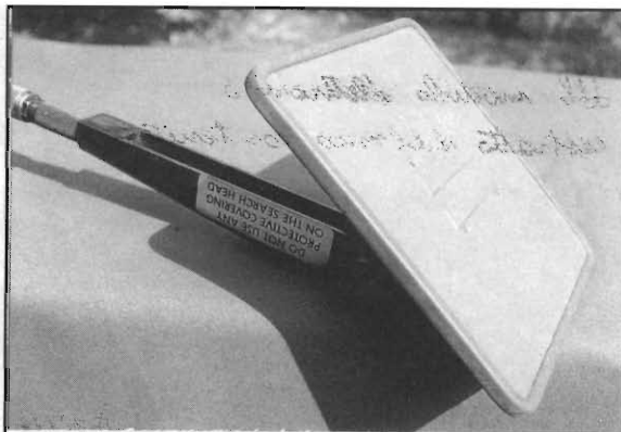
Parte inferiore della testa cercatrice. Parzialmente visibili le antenne simmetriche.
