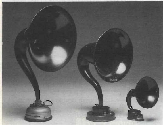
figura 3 - Altoparlante a tromba a collo di cigno. La cuffia è posta nel basamento. (Fotografia avuta dal Museo della RADIO della RAI di Torino.
