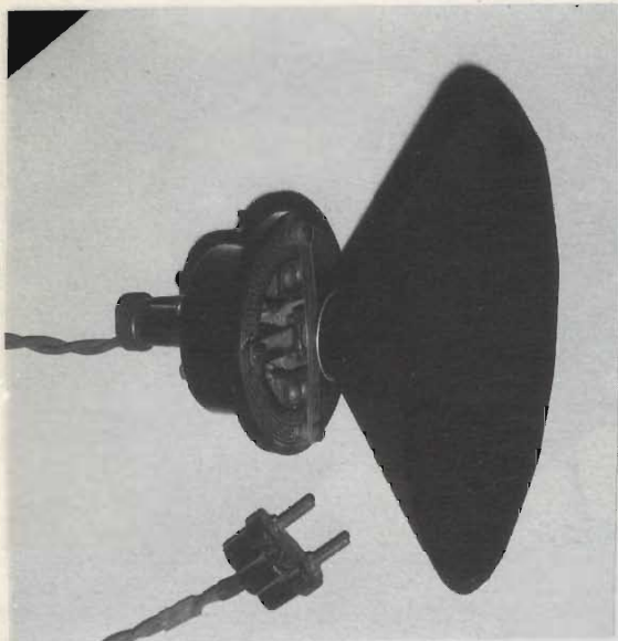
figura 7 - Altro altoparlante a spillo: è visibile la lamella vibrante. L'asticina lunga 1 cm non è visibile.
