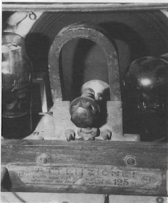
figura 6 - Altoparlante a spillo montato entro radoricevitore. Notare la manopola per la centratura della lamella vibrante.
