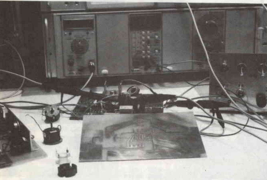
foto 6 - In primo piano la PC.S. in versione definitiva, rocchetto e seminucleo a Olla, in secondo piano una induttanza ad Olla completa.
