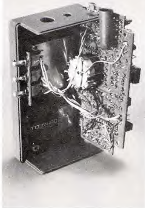
Figura 3. Il circuito stampato dovrà essere montato su distanziali, in modo da lasciar spazio, al di sotto di esso, per la batteria, i pulsanti ed il corpo di S2.
