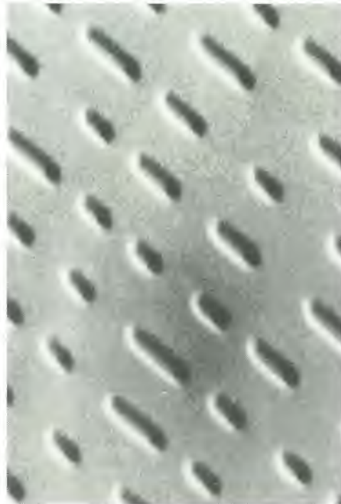
Figura 2. I dischi per memoria ottica vengono esplorati e scritti mediante un raggio laser. La struttura di un disco di questo genere, è mostrata nella Foto 1.
