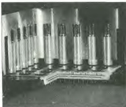
Figura 5. Substrati di ceramica supportano ed isolano i chip che compongono l'elaboratore 3081 della IBM.
