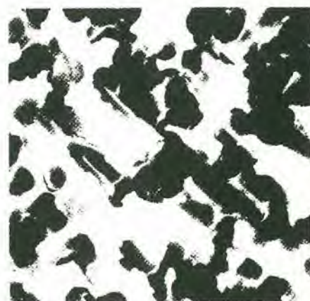
Figura 6. Un ingrandimento di 2500 volte di una superficie incisa di alluminio, del tipo adottato per i condensatori elettrolitici. Grazie all'attacco chimico, la superficie attiva aumenta moltissimo (Siemens data book 1980/81).
