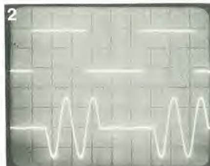
Foto 2. La tensione al carico.
