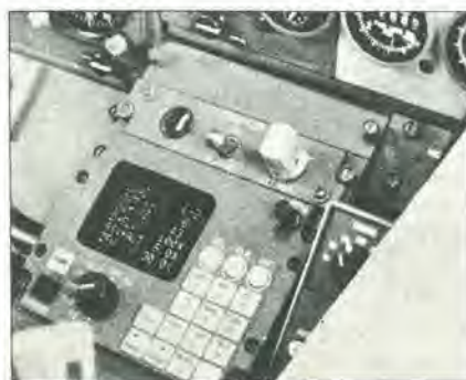
Figura 1. L'ultima conquista: il calcolatore del rendimento dei motori
