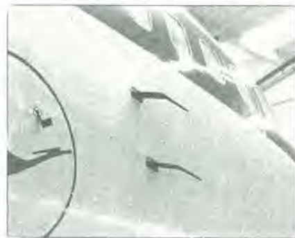
Figura 3. I contatti con il mondo esterno: tubi di Pitot e sensori per il rilievo della velocità relativa dell'aria.
