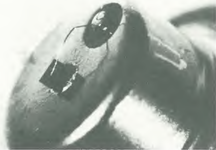
Foto 3. Un chip a LED montato in un contenitore TO-18.
