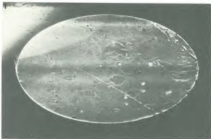
Foto 1. Radiografia di un wafer di carburo di silicio, che potrà essere usato nonostante le evidenti irregolarità.
