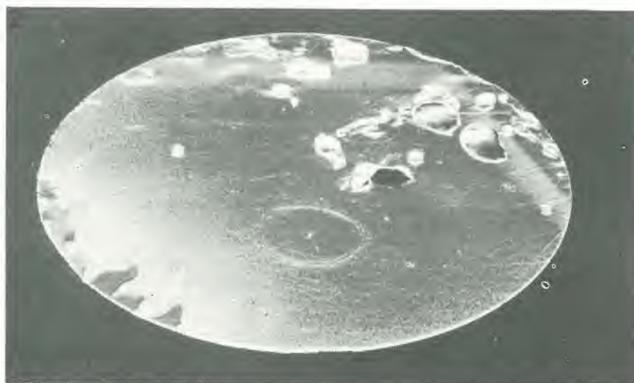
Foto 2. Radiografia di un wafer di silicio gravemente danneggiato.
