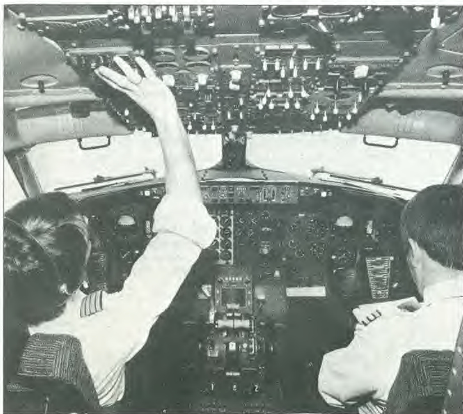
Figura 2. Il posto di lavoro del pilota e del copilota: tutti gli apparecchi di servizio sono a portata di mano e sono disposti secondo un ordine logico.
