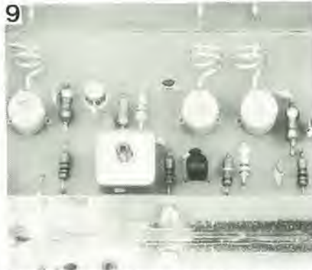
Foto 9. Le bobine a nucleo d'aria L9, L10 ed L12, che appartengono al moltiplicatore da 288 MHz. L9 ed L10 vengono piegate leggermente per ravvicinarle ed ottenere così un accoppiamento critico nel filtro passabanda.
