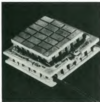
Figura 6. Collegamento in cascata. I moduli possono essere collegati in serie dal punto di vista termico per aumentare \Delta T . Le piastre di rame visibili sopra il modulo, servono al collegamento termico mediante saldatura. Queste piastre di rame non sono elettricamente collegate ai sottostanti elementi semiconduttori.
