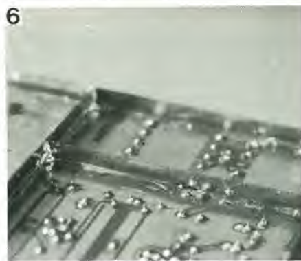
Foto 6. Il carico fittizio deve essere schermato su tutte e due le facce della bassetta. Qui è mostrata la parte superiore. Gli schermi debbono essere saldati per tutta la lunghezza dei margini di unione.
