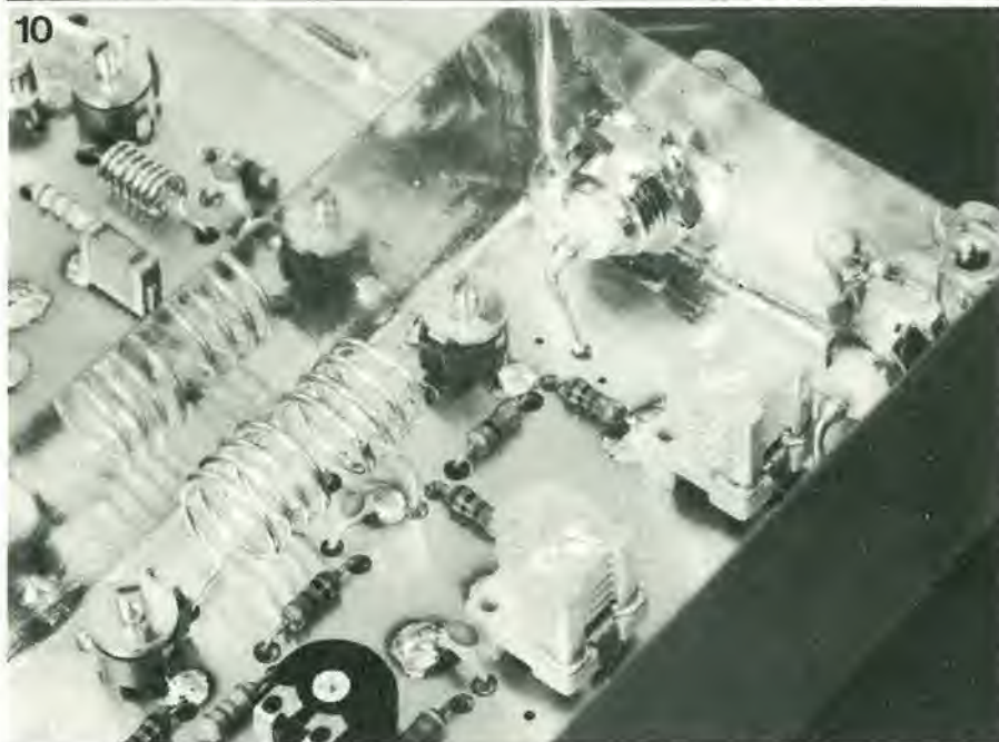
Foto 10. L'uscita del convertitore di ricezione consiste nelle bobine in aria L18 ed L19, seguite talvolta da un circuito attenuatore. Si osservi come sono montate queste bobine!
