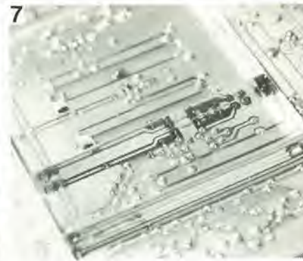
Foto 7. Lo schermo tra le sezioni a 374,4 ed a 432 MHz del convertitore d'uscita. Il risultato sarà una migliore soppressione del segnale a 374,4 MHz.
