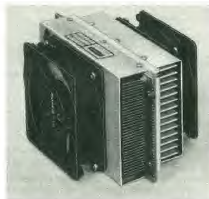
Figura 4. Raffreddamento di strumenti. Scambiatori di calore termoelettrici da aria ad aria raffreddano l'interno di una scatola sigillata contenente uno strumento elettronico. Lo scambiatore è montato sulla parete della scatola con il lato freddo affacciato verso l'interno. I moduli TE sono disposti a sandwich tra due dissipatori termici.
