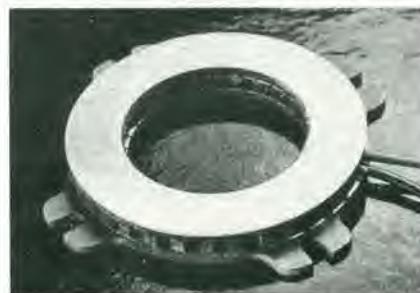
Figura 1. Pompe di calore elettroniche. Questi moduli termoelettrici sono delle pompe di calore elettroniche allo stato solido. Con un'adeguata alimentazione elettrica, si attiva il pompaggio del calore da una faccia all'altra dell'elemento. Si possono raffreddare degli oggetti molto al di sotto della temperatura ambiente.
