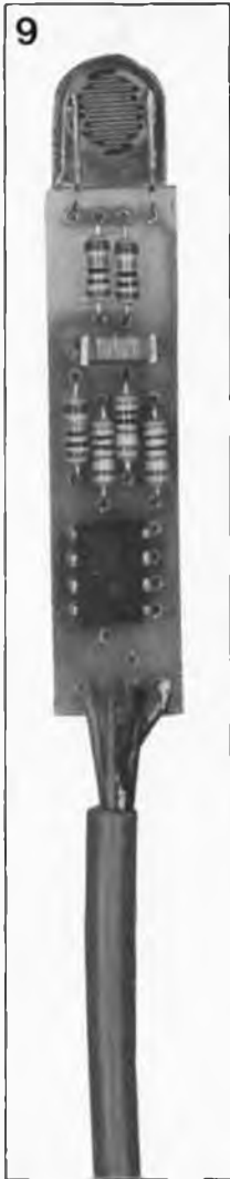
Figure 9. Vue d'un exemplaire terminé du détecteur d'ensoleillement.
