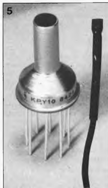
Figure 4. Schéma du dispositif de mesure de la pression atmosphérique. On y retrouve le capteur de pression classique, un KPY10.
