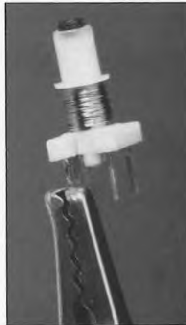
Figure 10. Il vous faudra réaliser vous-même la bobine L1 du VCO. La photo du haut montre l'embobinage à effectuer sur le corps de plastique; la photo du bas illustre l'aspect de L1 après mise en place du tore de ferrite cylindrique. L'inductance de L1 est de 22 μH environ.
