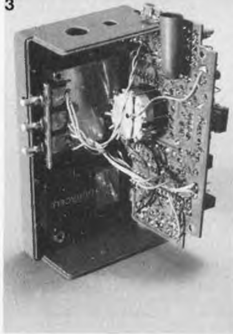
Figure 3. Rien de tel qu'un boîtier aux dimensions adéquates. La pile, le commutateur et les boutons-poussoirs habitent au rez-de-chaussée. Remarquez la position des photo-diodes côté pistes. D3 est pourvue d'une gaine.
