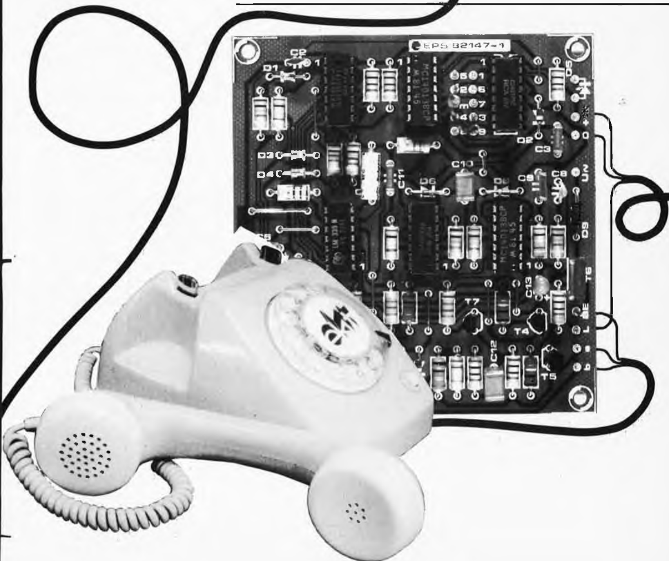
Figure 6. Si la sonnerie des appareils dont vous disposez n'est pas dotée d'une connexion distincte des points a et b, il faudra la modifier conformément aux indications du schéma 6b.
