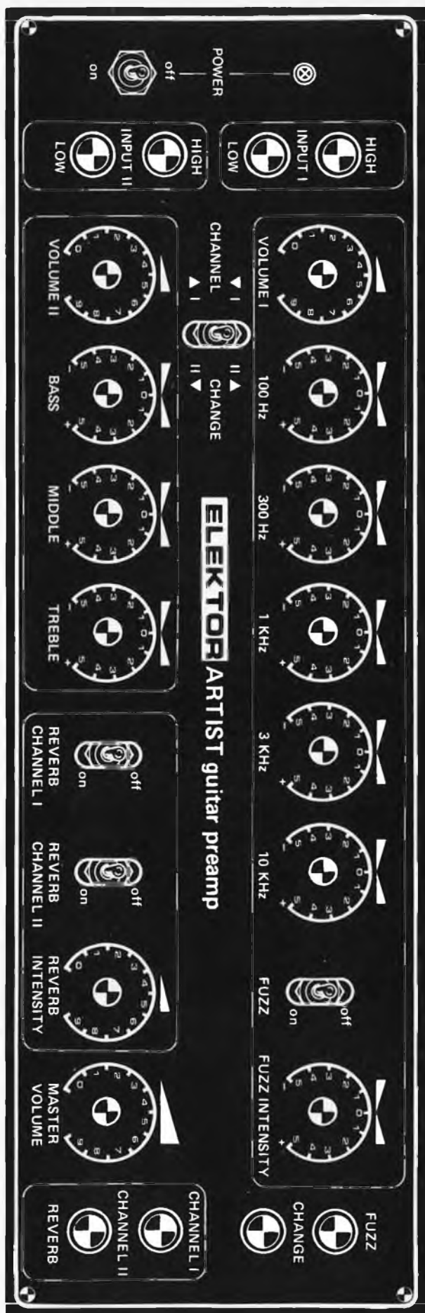
Figure 4. Il s'agit d'une proposition de face avant qui permet de résumer en un seul coup d'œil toutes les possibilités du préamplificateur.
