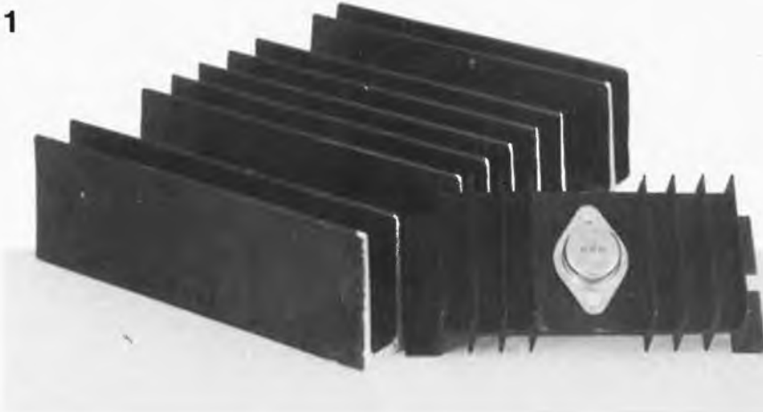
Photo 1. Voici deux types de profil fort utilisés comme radiateurs. A droite, un profil très courant: le SK03 et tout à côté, un très grand profil: le SK53, dont la résistance thermique n'est que de 0,5^{\circ}C . L'utilisation de radiateurs d'une telle taille ne se justifie (économiquement) pas dans la plupart des cas.
