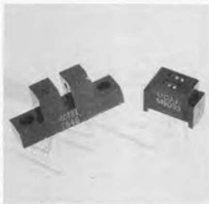
Photo 3. Il existe deux types (au moins) de capteurs électroniques utilisables ici. A gauche, le type à fourche que nous préconisons pour ce montage, et à droite le type à réflexion, également utilisable.
