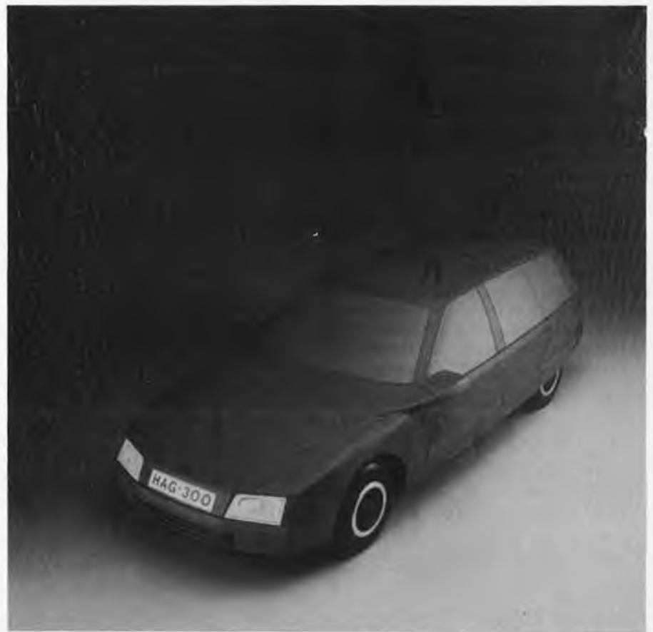
Photo 1, Photo 2. Modèle de voiture conçu par un groupe d'études universitaires sous le patronage du Ministère de la Recherche et de la Technologie d'Allemagne Fédérale, dans le cadre d'une mission intitulée "la voiture de l'avenir". Outre une ligne aérodynamique ( c_w = 0,29 ), la carrosserie témoigne du souci de la sécurité du piéton sous la forme de revêtements de mousse de nylon sur les parties avant dépourvues d'angles saillants, ce qui contribue également à l'édification d'une sorte de chambre acoustique autour du moteur. Détail intéressant, les rétroviseurs extérieurs sont intégrés dans le profil de la carrosserie afin de faciliter l'écoulement des filets d'air. (Source: Hochschul-Arbeitsgemeinschaft)
