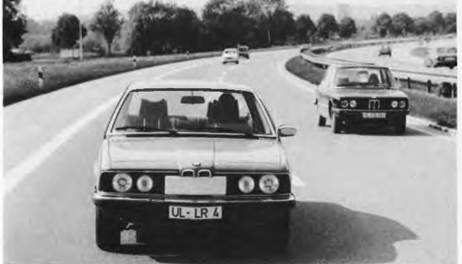
Photo 3. Véhicule expérimental équipé d'un radar de contrôle de distance.
