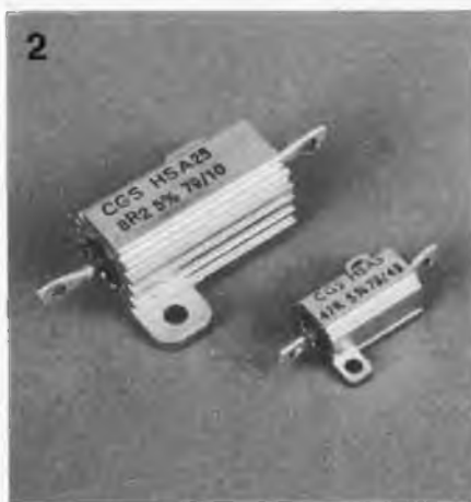
Photo 2. Les résistances R1 et R20 sont des modèles spéciaux de puissance que l'on peut fixer au châssis à l'aide de vis et d'écrous.
