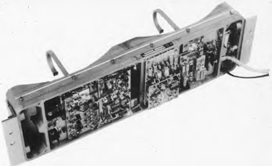
Photo 2. Prototype du radar de contrôle de distance de AEG-Telefunken. Le circuit électronique intégré dans le boîtier d'antenne se compose d'un émetteur, d'un récepteur et d'un calculateur. Ce dernier comporte un "évaluateur de danger" réalisé avec un microordinateur 8 bits.
