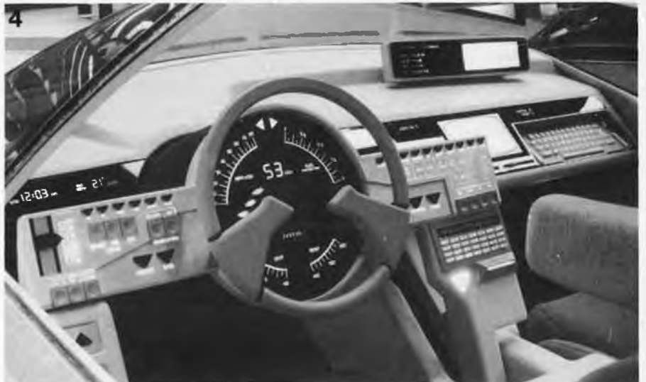
Photo 4. Cockpit du projet de réalisation Probe I de Ford. L'ordinateur de bord ne sert pas seulement à délivrer des informations sur l'état du véhicule; il joue également le rôle de micro-ordinateur de bureau et de terminal radio. Que désirer d'autre après cela?
