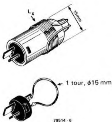
Figure 6. Ce dessin montre clairement la façon de fabriquer les bobines. Il est important d'éloigner au maximum les bobinages de toutes parties métalliques afin de limiter les pertes fer.
