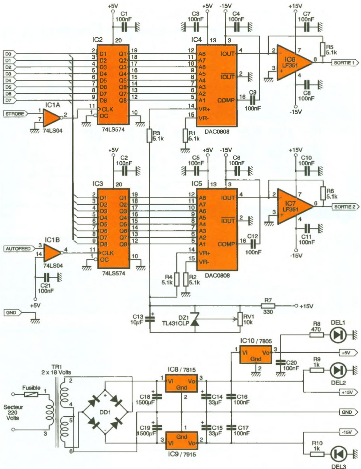
Si l'on désire obtenir la précision maximale, les résistances  $R_1$ ,  $R_2$ ,  $R_3$  et  $R_4$  fixant les courants de référence devront être des modèles de précision à tolérance de 1%, ou mieux; idem en ce qui concerne  $R_5$  et  $R_6$ . Ces résistances devront alors avoir une valeur de  $5\text{ k}\Omega$ . Si l'on se contente d'une moindre précision, on utilisera des résistances de  $4,7\text{ k}\Omega$  à 5% triées dans un lot.
