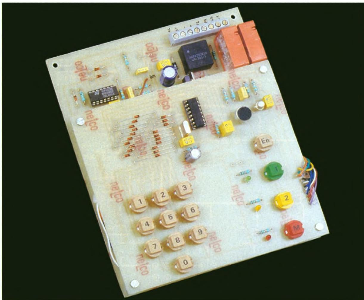
Le montage étant achevé, procédez au contrôle final comprenant la vérification de la valeur et de la polarité des composants ainsi que des soudures. En cas de doute, n'hésitez pas à vous référer aux photos correspondantes. En dernier lieu, placez les circuits intégrés sur leur support respectif, en veillant soigneusement à l'orientation.
