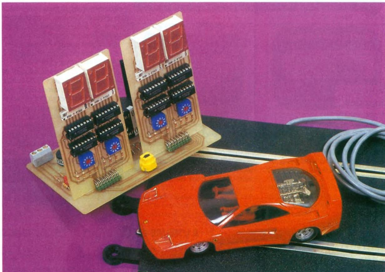
**Ce double compte-tours digital a été spécifiquement élaboré en vue de son utilisation dans un circuit automobile miniature afin d'y ajouter un intérêt ludique. Il peut, moyennant quelques légères modifications, être utilisé comme compteur-décompteur universel prépositionnable avec relais d'utilisation extérieur.**
