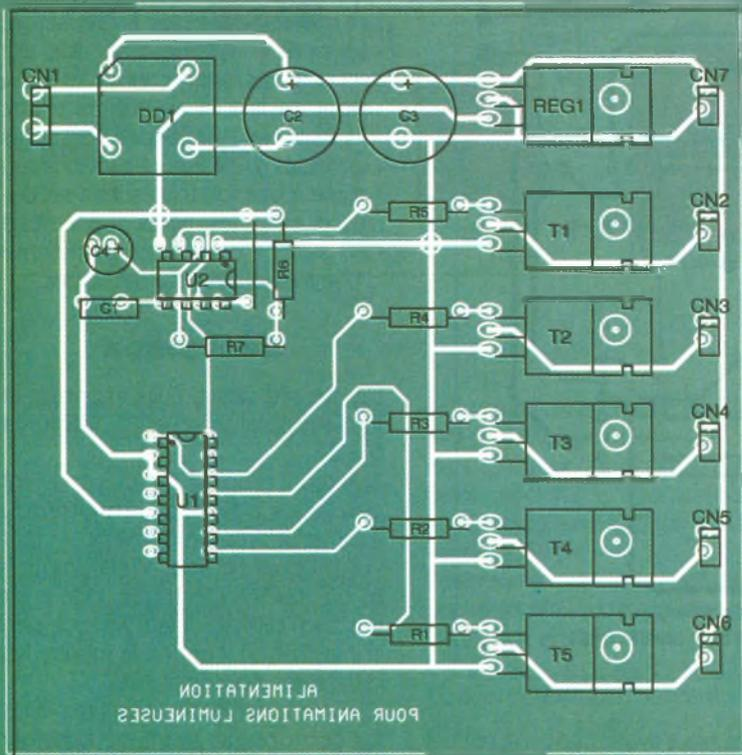
REG<sub>1</sub>, T<sub>1</sub> à T<sub>5</sub>, il faudra percer avec un foret de 1 mm de diamètre.
