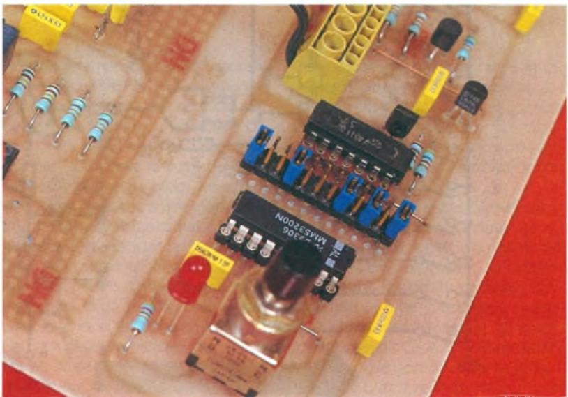
Vient ensuite le CI du modem (IC<sub>1</sub>). Le bouton-poussoir connecté entre la masse et la broche 5 sera un modèle inverseur : la masse sera connectée en permanence, ce qui positionnera le modem en réception. Par appui sur ce poussoir, la masse sera déconnectée et l'on passera en émission. Aux broches 3 et 4, on dispose du signal de sortie. Après passage dans le filtre composé des résistances R<sub>2</sub>,
