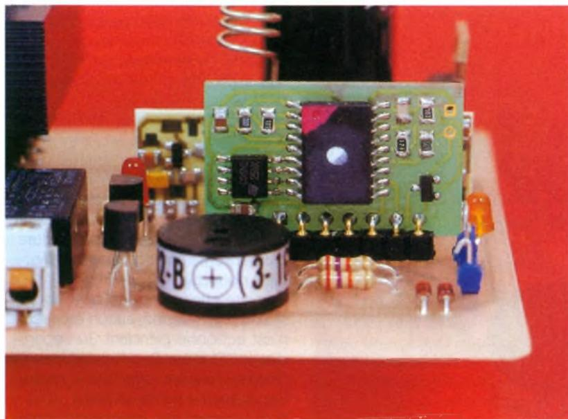
La broche 3 peut être mise à la masse par un strap amovible et commande le début de la phase d'apprentissage.
