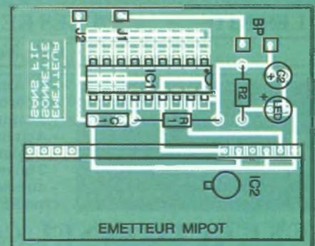
tiques, branchez la pile de l'émetteur et la prise du récepteur. Un appui sur le bouton de l'émetteur devra se traduire par un carillon trois notes sur le haut-parleur du récepteur. Si ce n'est pas le cas, débranchez, et vérifiez les pistes et les soudures pour les deux montages.
