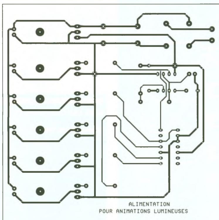
soient alimentées par une source de courant, il est quand même nécessaire d'ajouter les résistances  $R_2/R_3/R_5$  pour équilibrer le courant dans les différentes branches. L'effet lumineux obtenu sera ainsi plus agréable, quelle que soit la couleur de diodes DEL que vous utiliserez. Pour animer les différents motifs lu-
