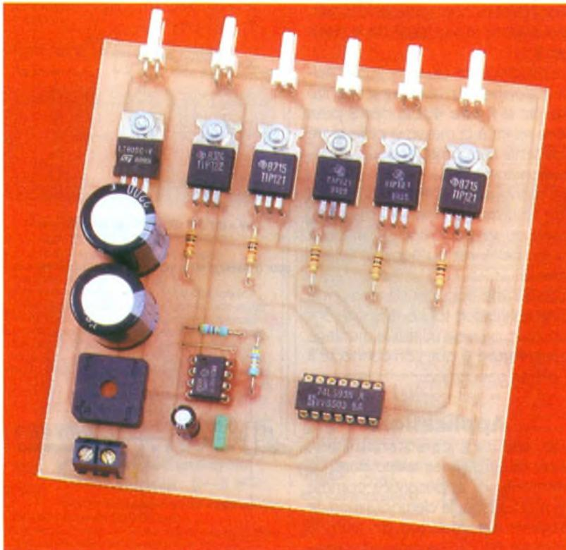
**REG<sub>1</sub>** : régulateur LM7805 en boîtier TO220
