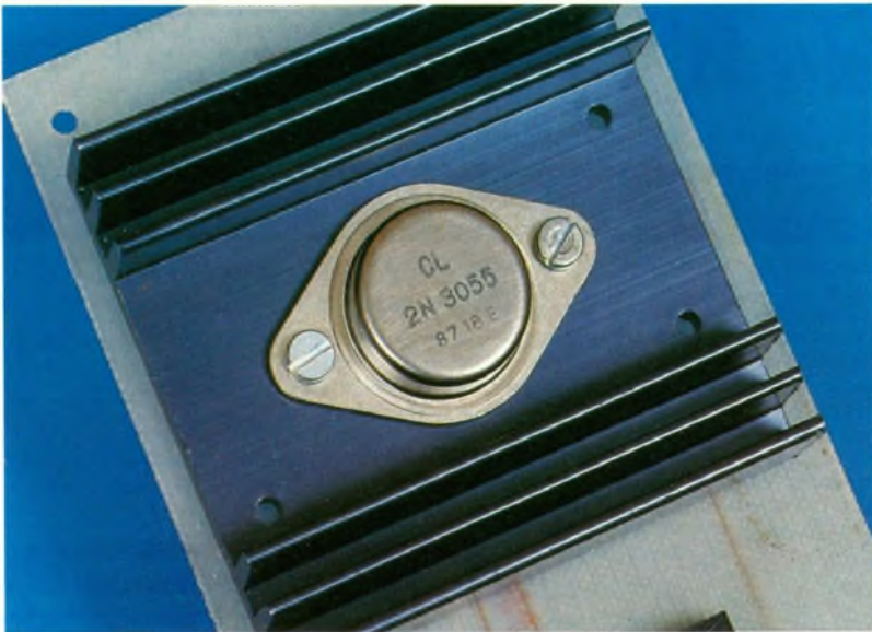
Photo 3 - Gros plan sur le transistor de puissance.
