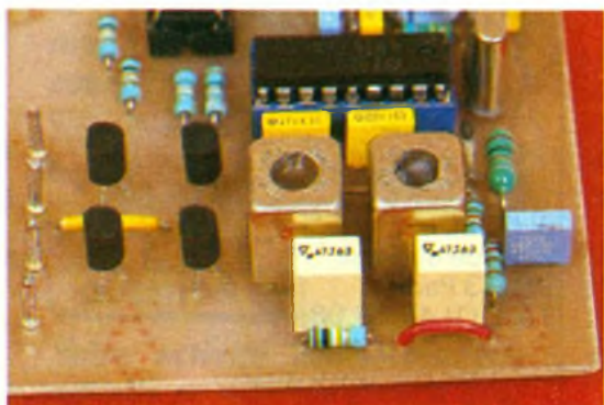
Photo 4 – Vue des transformateurs F1.
