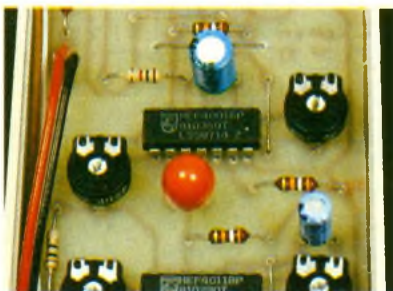
Photo 3. – En rouge, utilisation d'un condensateur tantalé
