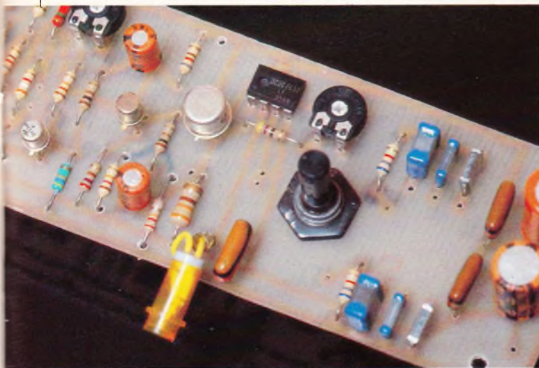
Photo 2. - Gros plan sur l'ampoule miniature 6 V, 40 mA.
