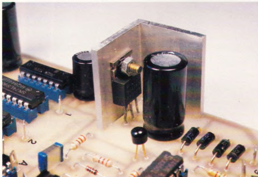
Photo 3. - Gros plan sur le dissipateur de IC_{10} .
