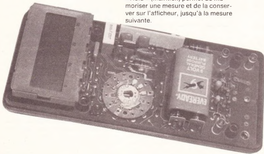
Vue intérieure du multimètre.
