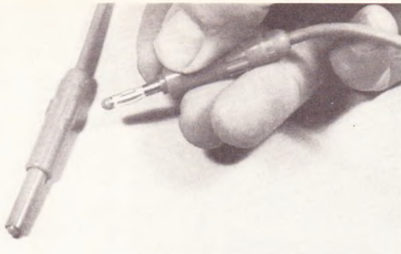
Photo 7. – Plus de courts-circuits avec ces fiches bananes rétractables.
