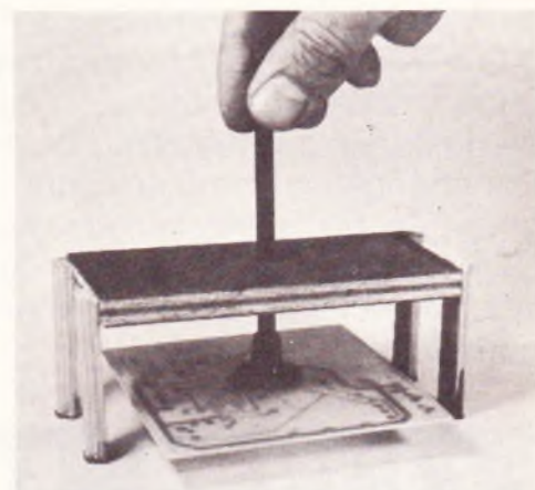
Photo 3. – Le circuit fixé à la ventouse et le tout dans le perchlore sans se salir les doigts.
