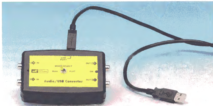
Figure 17 : Voici un des prototypes du convertisseur audio stéréo USB monté dans son boîtier plastique et prêt à être utilisé soit pour mémoriser vos disques vinyles (ou autres sources audio) soit pour écouter sur la chaîne HI-FI les fichiers numérisés.
