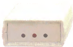
Figure 1 : Photo d'un des prototypes de la platine de l'alarme antivol radar à 10 GHz EN1396. Pas besoin de pratiquer une découpe dans le couvercle, car à cette fréquence les ondes traversent le plastique sans aucune atténuation.
