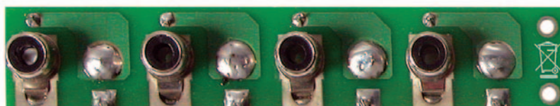
Figure 15: Photo d'un des prototypes de la platine de la section Audio du commutateur vidéo.
