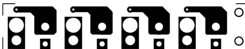
Figure 14b-2: Dessin, à l'échelle 1, du circuit imprimé double face à trous métallisés de la platine de la section Audio du commutateur vidéo. Les deux étant symétriques, ces appellations (côté soudures et côté composants) n'ont qu'un rôle de repérage.
