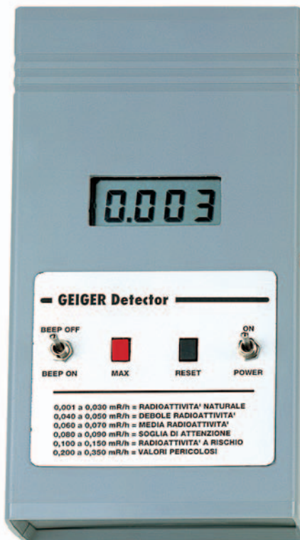
Figure 1: Voici (de même qu'en photo de première page) le compteur Geiger EN1407 décrit dans le numéro 94 d'ELM et que le présent article vous propose de modifier afin d'en améliorer les prestations. Les deux flèches rouges indiquent la position des deux fentes rectangulaires dans lesquelles vous devez faire levier avec la lame d'un tournevis lorsque vous souhaitez ouvrir le boîtier plastique.
