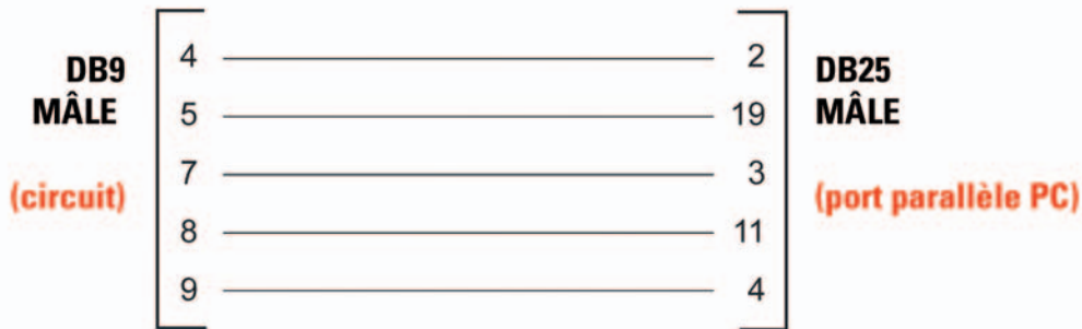
Figure 4: Le programmeur peut être géré par le port parallèle: il suffit pour cela de réaliser un câble adaptateur suivant ce (très simple) schéma.
