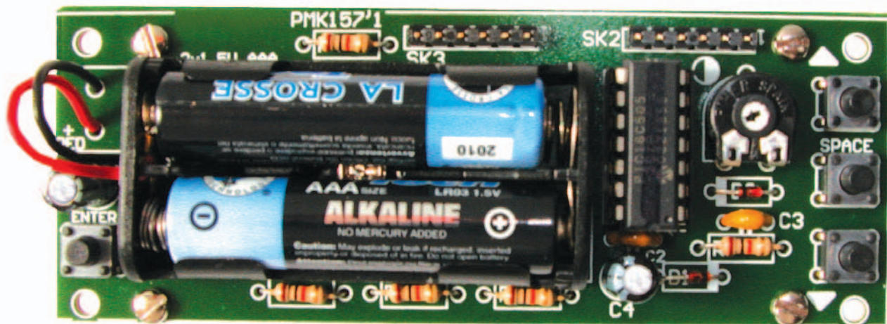
On aperçoit les quatre poussoirs de paramétrage et le trimmer de réglage de la luminosité.
