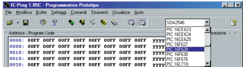
Figure 33: Avec le programme IC-Prog et notre programmeur il est possible de programmer de nombreux types de PIC (voir tableau1). Pour essayer la platine d'expérimentation EN1582, sélectionnez dans le menu déroulant le PIC 16F628.
