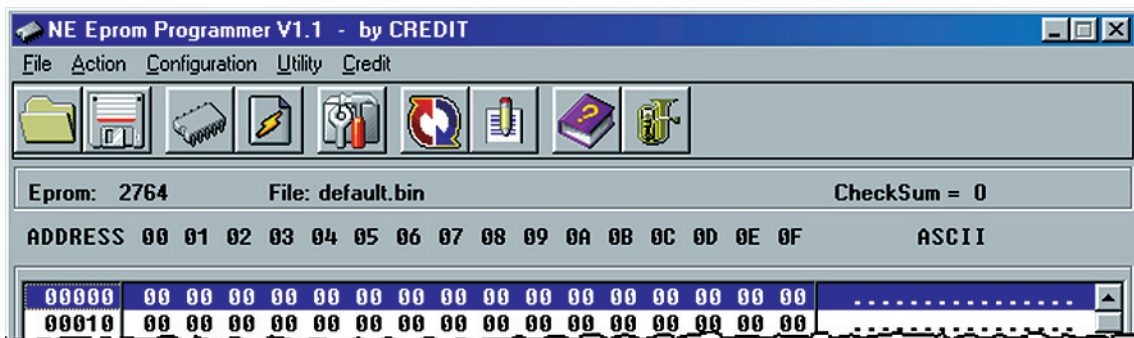
Figure 1: Après avoir installé le programme NEprom sur votre disque dur et l'avoir lancé, l'écran principal est visualisé. Sous la barre d'outils vous pouvez lire le type d'EPROM (2764), le fichier à transférer (default.bin) et la valeur de "ChekSum", soit la dernière localisation occupée de l'EPROM.
