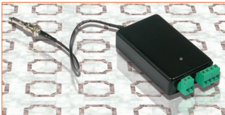
Figure 4: Platine de l'alarme téléphonique GSM installée dans son boîtier plastique type SC/700.
