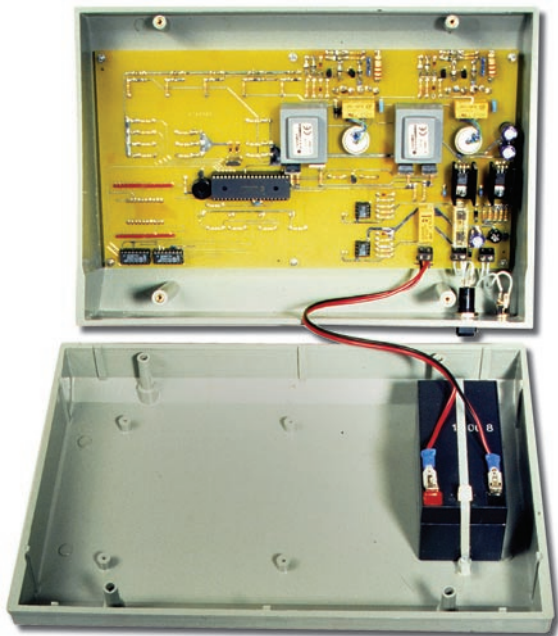
Figure 8 : Le montage dans le boîtier de la platine et de la batterie rechargeable.
