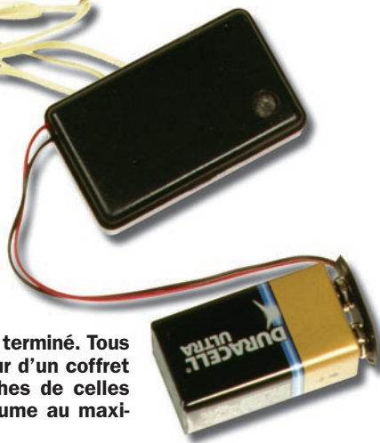
Figure 11 : Le récepteur a été installé dans un petit coffret plastique muni d'un compartiment pour pile de 9 volts. A l'aide du potentiomètre, il est possible de régler le niveau d'écoute sur casque ou sur un petit haut-parleur.
