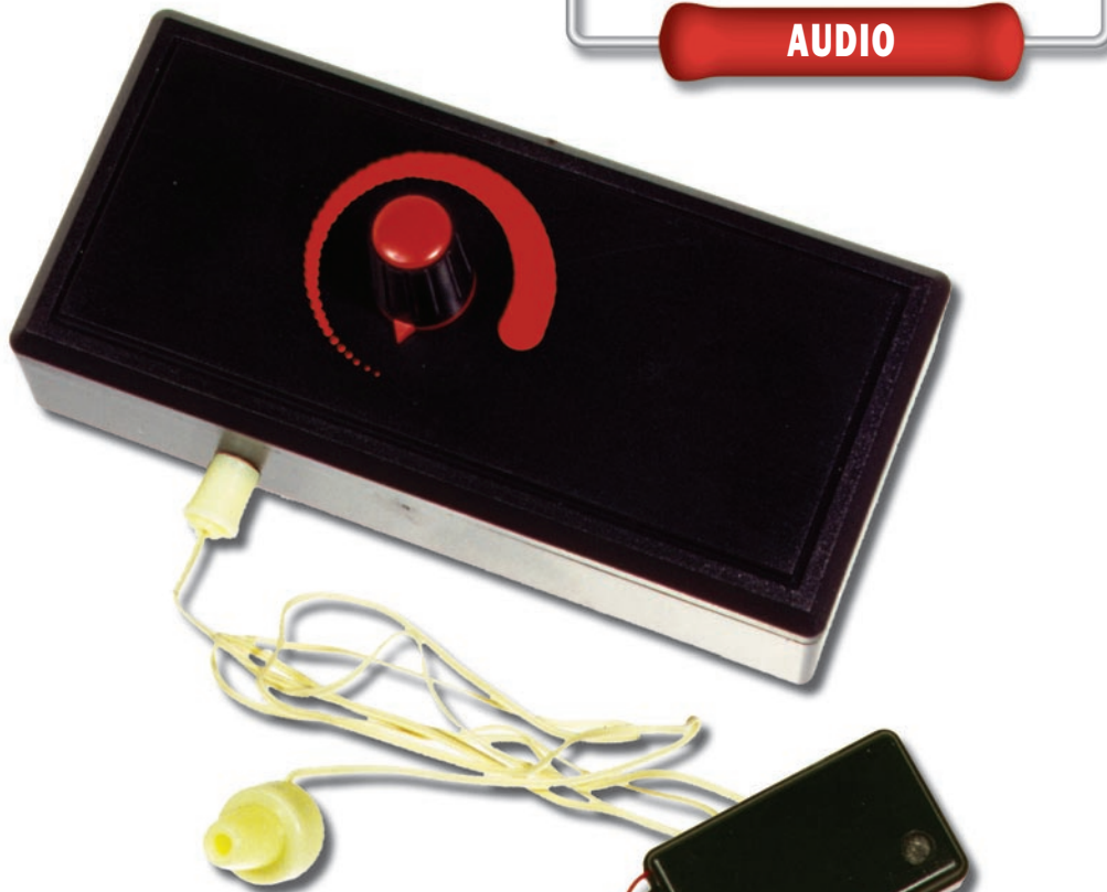
Figure 11 : Le récepteur a été installé dans un petit coffret plastique muni d'un compartiment pour pile de 9 volts. A l'aide du potentiomètre, il est possible de régler le niveau d'écoute sur casque ou sur un petit haut-parleur.
