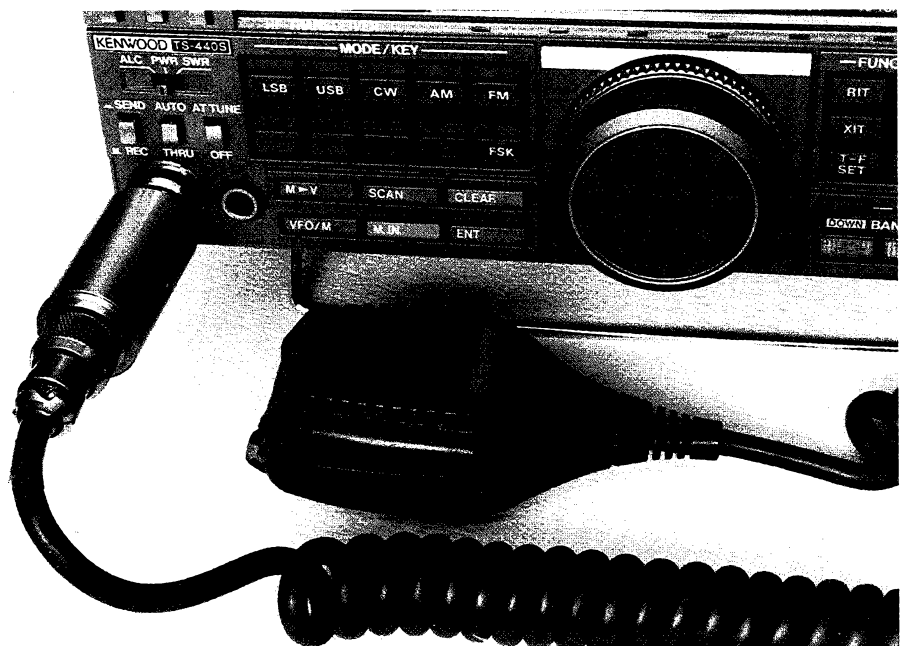
Fig.1. Anjo Eenhoorn, PAoZR, monteerte een schakeling voor een einde-uitzending-toon ("rogerpiep") in een busje dat tussen de stekker en de aansluiting voor de microfoon op zijn TS-440S komt. (Foto: PAoZR.)
