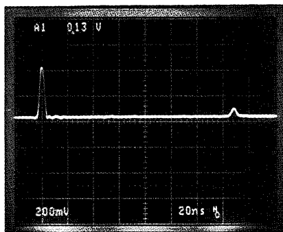
Fig. 3a. Ingaande puls en reflectie van een te hoogohmig afgesloten kabel. De reflectie heeft dezelfde polariteit als de puls.
